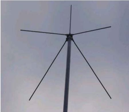
19 Tête d'antenne avec dipôle et radiaux de contrepoids
