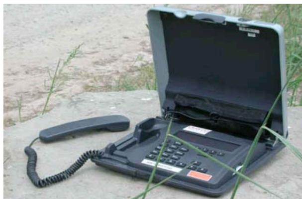
L'antenne satellite est intégrée au couvercle du boîtier
